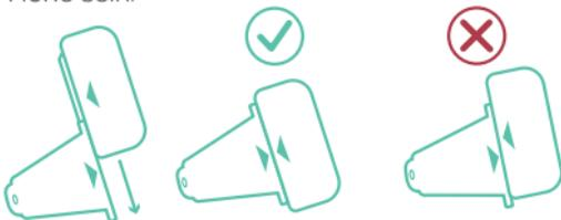
Wenn der Sensor richtig ausgerichtet ist, befestigen Sie die kleine Schraube, um die zwei Elemente zu fixieren und ihn so vor Diebstahl zu schützen. Alternativ können Sie die Schraube weg lassen, um den Sensor immer wieder mitnehmen zu können.
