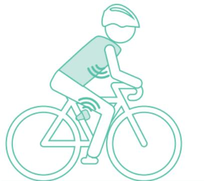
L'airbag B'Safe utilise un algorithme et deux capteurs capables de distinguer les mouvements normaux d'un cycliste de ceux d'un accident. Le capteur CDU (crash detection unit), intégré dans la veste, analyse les mouvements du cycliste en temps réel et le capteur selle SDU détecte les chocs. Quand un choc ou un mouvement anormal est détecté, les deux capteurs communiquent ensemble et analysent la situation. **Lorsqu'un accident est détecté, l'airbag se gonfle en 80ms et le cycliste est protégé.**
