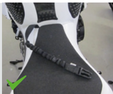
Installazione alla moto con un cappio
